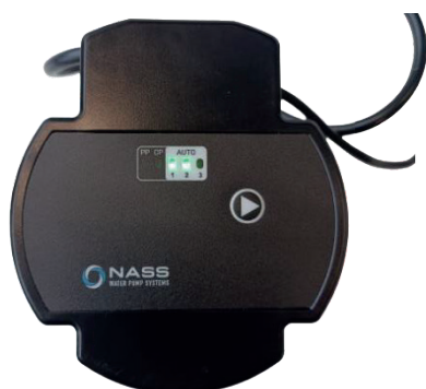
Modo NORMAL (LED 1 y 2 encendidos)
